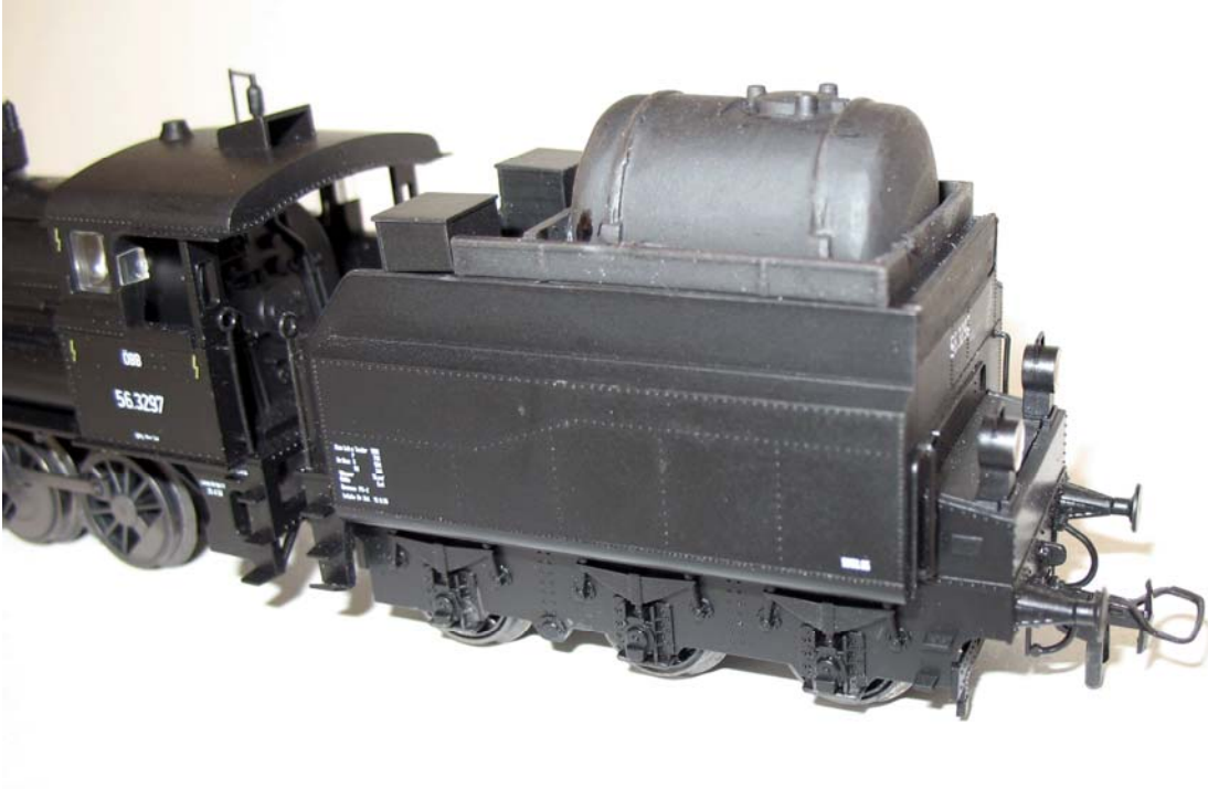
Abb.7: Der fertige Tender mit Öl-Zusatztank in Grossaufnahme
